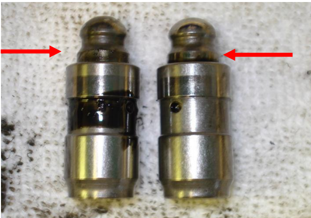
Bild 3: Hydrostößel li. maximal ausgefahren, Ventile dichten nicht
