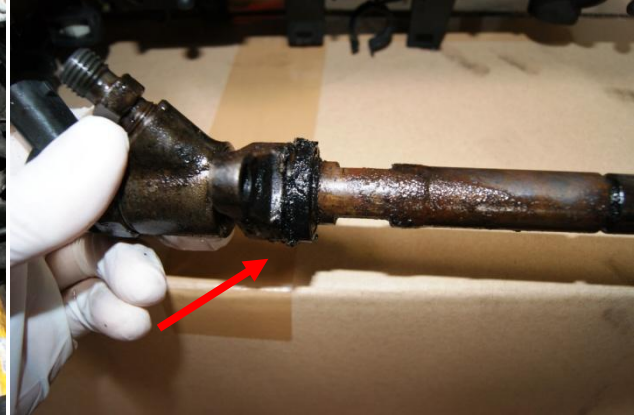
Bild 2: Halterung am Düsenstock undicht
